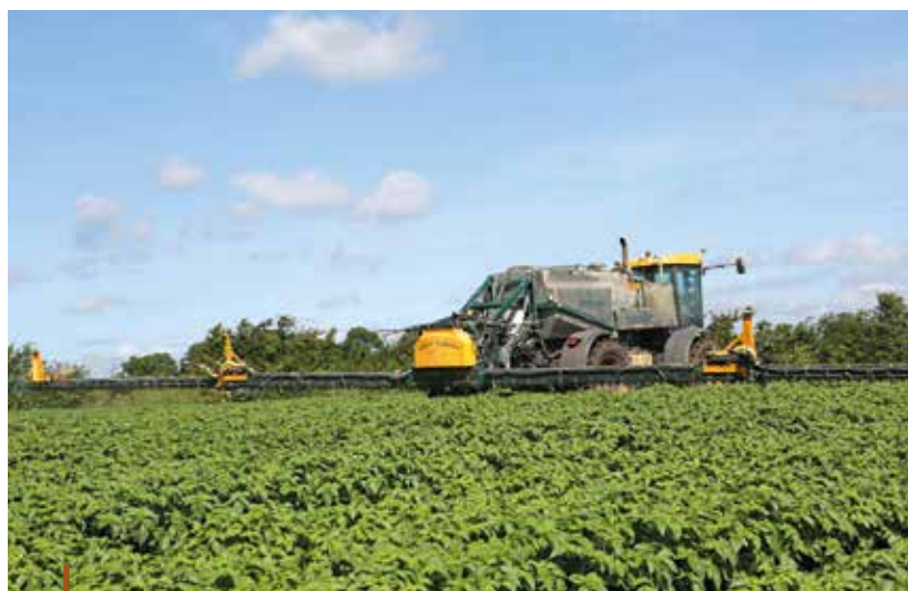
Plantacje ziemniaków opryskiwane są samojezdnym opryskiwaczem marki Danfoil. Na jeden hektar stosuje się ok. 50 l cieczy roboczej.
